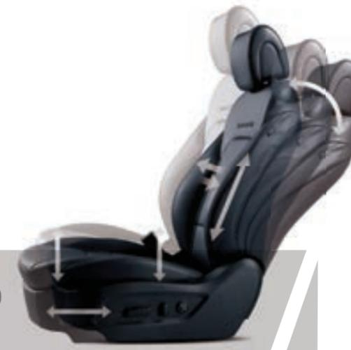
Сиденье водителя с электрорегулировкой в 12 направлениях (в том числе регулировка поясничной поддержки в 4 направлениях) позволяет не допустить усталости даже при длительном вождении.
