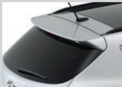
Задний спойлер со встроенным светодиодным стоп-сигналом.
