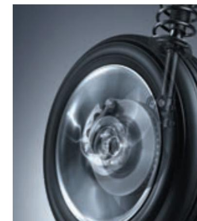
**Дисковые тормоза большого диаметра**
