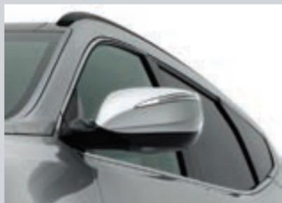
Светодиодные сигналы поворота, встроенные во внешние зеркала.
