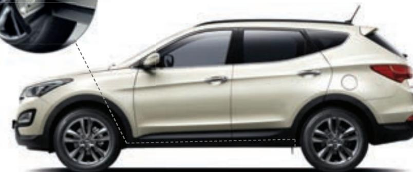
Конструкция уплотнителей дверей защищает пороги от грязи и сохраняет Вашу одежду в чистоте.
