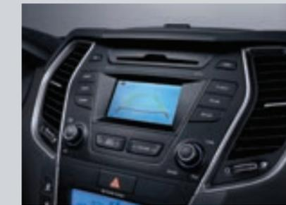
**Высококачественная аудиосистема.** На встроенный 4,3-дюймовый ЖК-дисплей (TFT) с сенсорным управлением выводится изображение с задней камеры, что повышает безопасность при движении назад.
