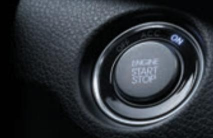
**Запуск двигателя кнопкой и бесконтактный ключ.**
