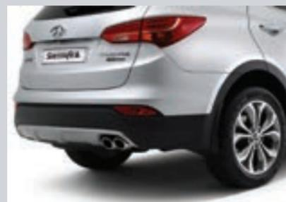
Сдвоенные патрубки выхлопной системы.
