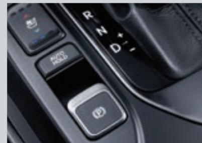
Электрический стояночный тормоз с автоматическим удержанием.
